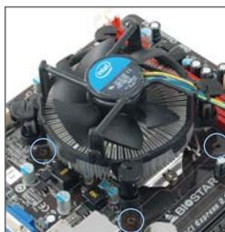
**步骤 2:** 依次把对角 2 个钉钩同时向下按，以固定风扇，完成 CPU 安装。
